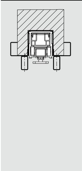
Wir empfehlen, die Aufhängung des Türflügels am CS 80 MAGNEO Antrieb mit Leisten zu verschatten. So ist ein einfacher Zugriff auf den Antrieb auch nach dem Verschließen der Wand gegeben.
