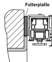
CS 80 MAGNEO Antrieb unterfüttert werden. DORMA bietet hierfür eine spezielle Futterplatte. Wenn AW größer als 15 mm ist, muss der Antrieb zusätzlich bauseits unterfüttert werden.
