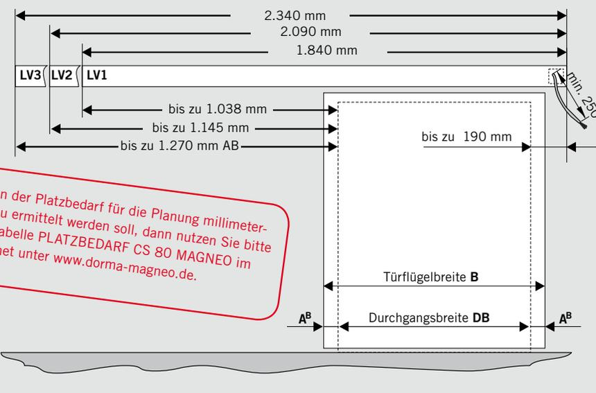
Die Abbildung zeigt eine nach links öffnende Schiebetür, die Stromzuführung (Netzanschluss 3 x 1,5 mm<sup>2</sup>) erfolgt von rechts. Analog dazu erfolgt bei einer rechts öffnenden Tür die Stromzuführung von links.
